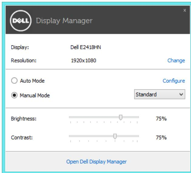
Caseta de dialog **Quick Settings** (Setări rapide) vă oferă și acces la interfața avansată cu utilizatorul a Dell Display Manager, care este utilizată pentru ajustarea funcțiilor Basic (De bază), configurarea modului Auto (Automat) și accesarea altor caracteristici.
