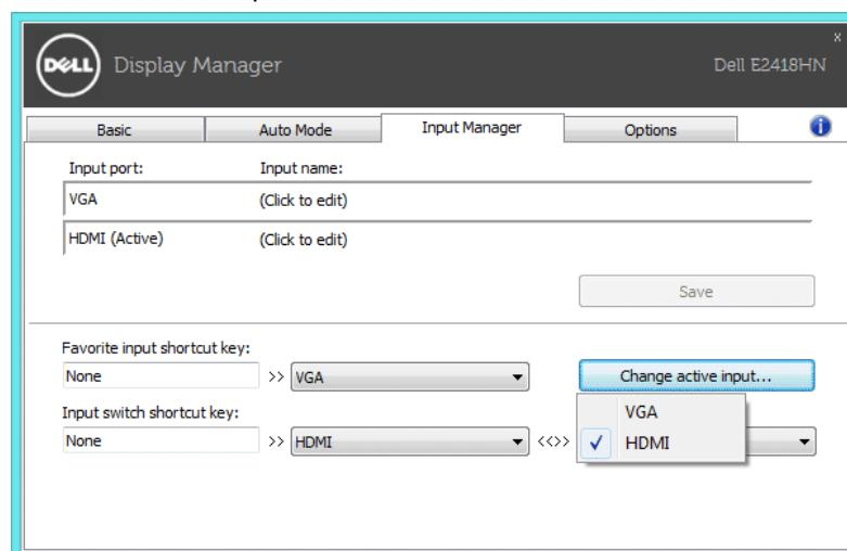
**NOTĂ:** Aplicația DDM comunică cu monitorul dvs. chiar și atunci când monitorul afișează semnal video de la un alt computer. Puteți instala aplicația DDM pe PC-ul pe care îl utilizați cel mai frecvent și puteți controla comutarea intrărilor de la acesta. De asemenea, puteți instala aplicația DDM și pe alte PC-uri conectate la monitor.
